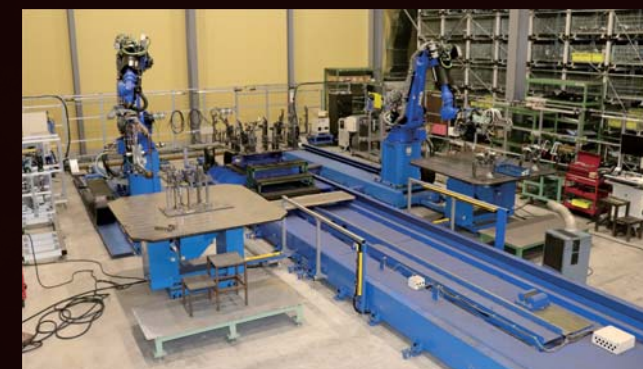
ツインスポット溶接ロボット設備
