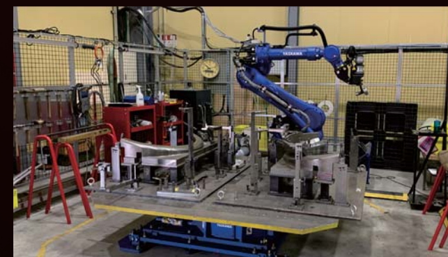
ヘミングロボット設備
