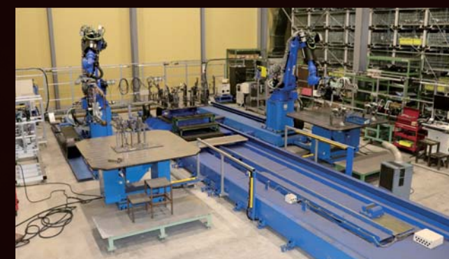
ツインスポット溶接ロボット設備
