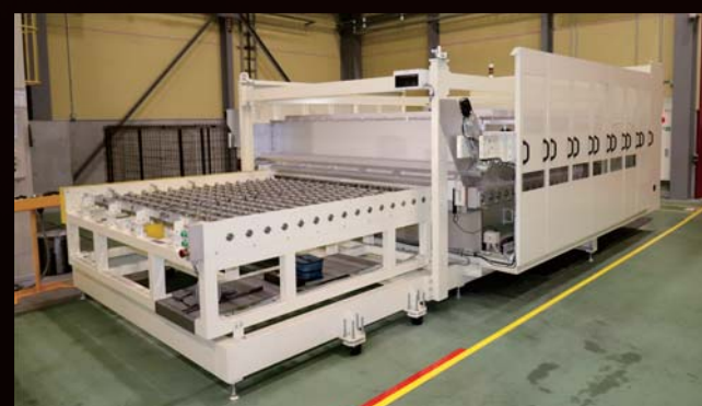
ホットプレス用加熱炉
