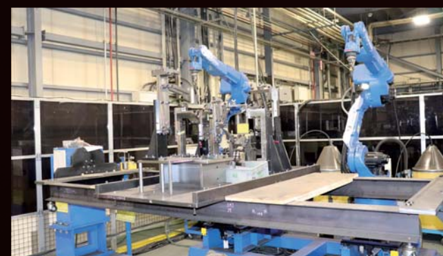
ツイン溶接ロボット設備
